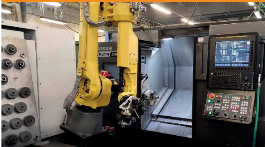
Robotická buňka pro zakládání dílů do soustruhu v Jemnici
