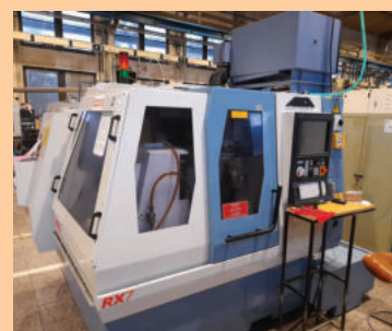
Repasovaná bruska pro výrobu a broušení nástrojů ANCA RX7
